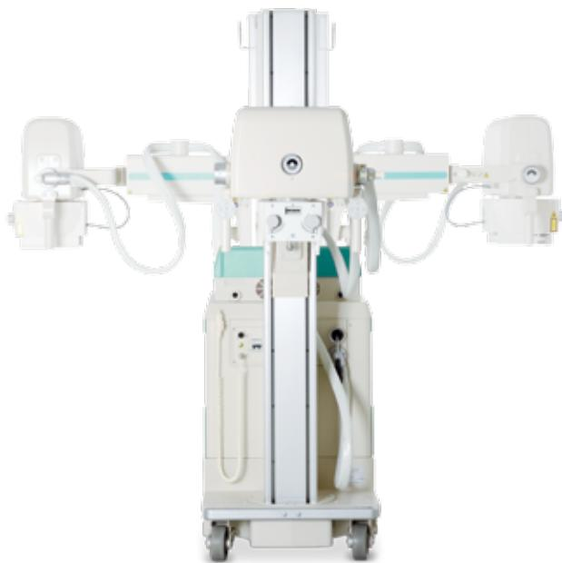
Le ampie movimentazioni del braccio telescopico, la completa rotazione del tubo radiogeno e le ridotte dimensioni dell'unità, permettono l'esecuzione di esami radiografici anche nelle condizioni meno agevoli, al letto del paziente o in reparti dove lo spazio disponibile risulta particolarmente ridotto (Terapia Intensiva, Sala operatoria).
