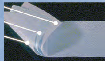
Vrstva spunbond meltblown spunbond
